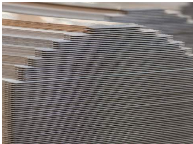
Núcleo con corte a 45° y apilado step-lap
