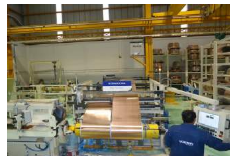
Fabricación de bobina de baja tensión
