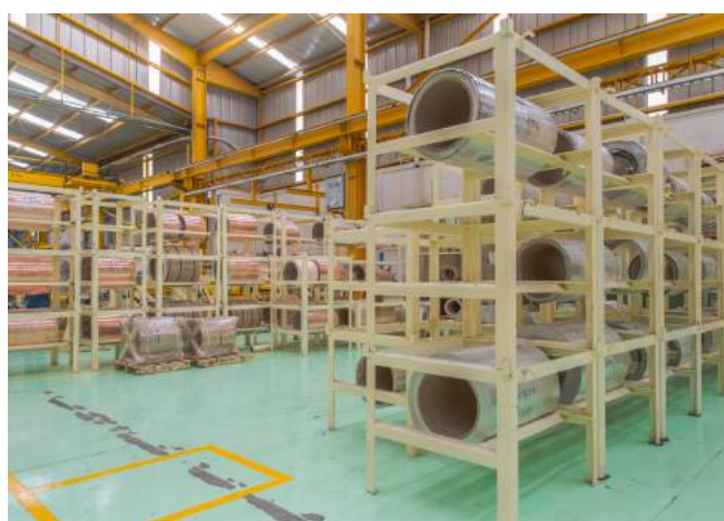
Almacén de aluminio y cobre para elaboración de bobinas de baja y alta tensión
