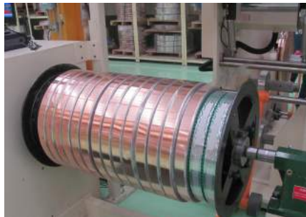
Fabricación de bobina de alta tensión
